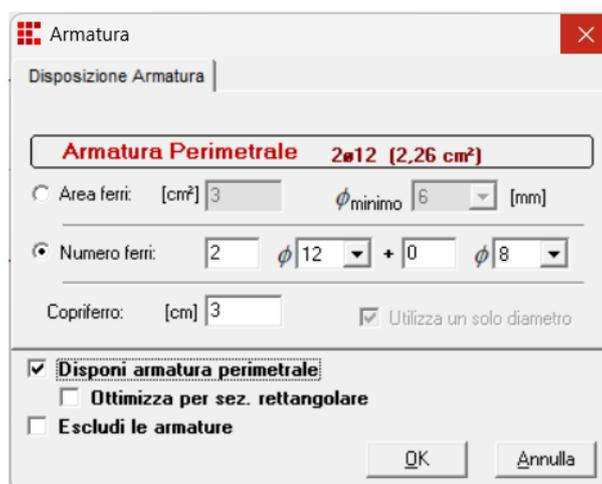
Fig. 4.9 - Impostazione di armatura perimetrale.
