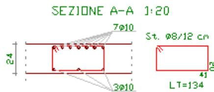
Fig. 7.12 - Sezione trave di contrappeso.
