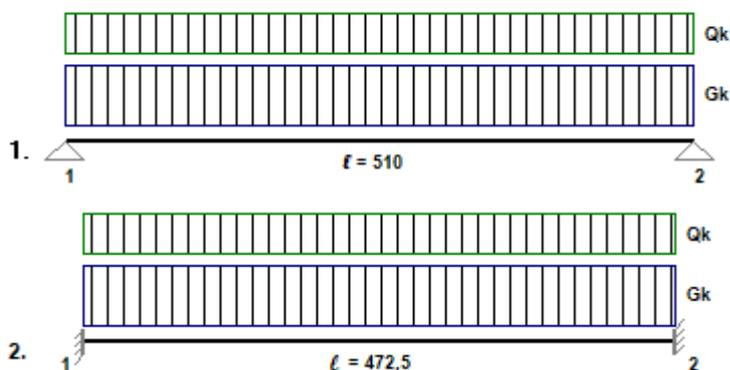
Solaio - Schema condizioni di carico
