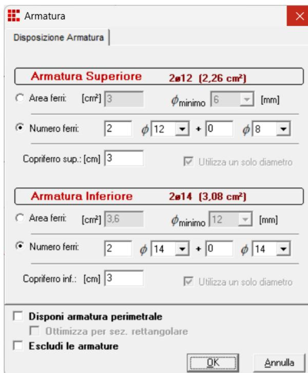
Fig. 4.8 - Impostazioni delle armature e del copriferro.
